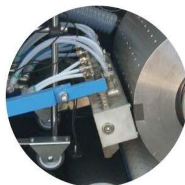
**Plotter** per incollaggio ad alta velocità per l'applicazione di colla a caldo "EVA-PSA", e colla a freddo vinilica. Con un semplicissimo sistema di auto apprendimento per mezzo di un joystick, guidato da un puntatore laser, e dotato di elettronica di ultima generazione, il plotter è in grado di realizzare tutti i profili desiderati.
