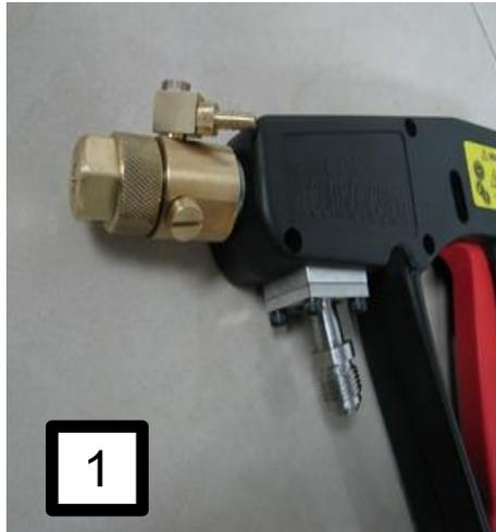
Grazie all'ampia gamma di accessori, è possibile personalizzare le pistole manuali in relazione al tipo di applicazione. Grazie infatti al montaggio di un kit ugello spray, è possibile convertire l'applicazione a tratto in applicazione spray.
