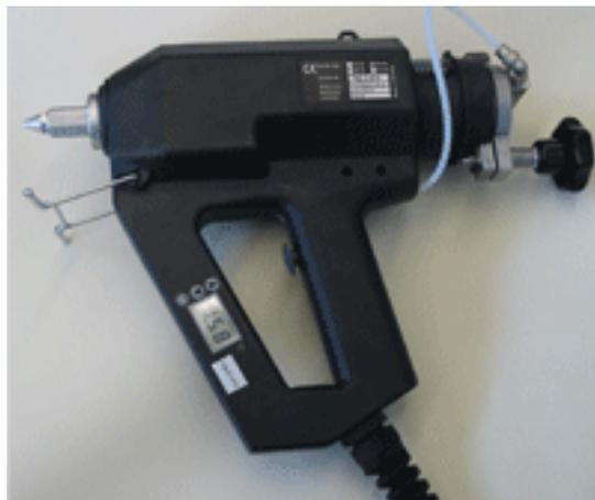
Le pistole manuali a cartucce sono particolarmente adatte per l'applicazione di PUR hot-melt. Garantiscono un rapido e sicuro cambio delle cartucce, così come un controllo ottimale della temperatura operativa, in quanto dotate di controllo elettronico delle temperature appositamente integrato all'interno del manico della pistola. Anche in questo caso è possibile adattare l'ugello a seconda dell'applicazione.
