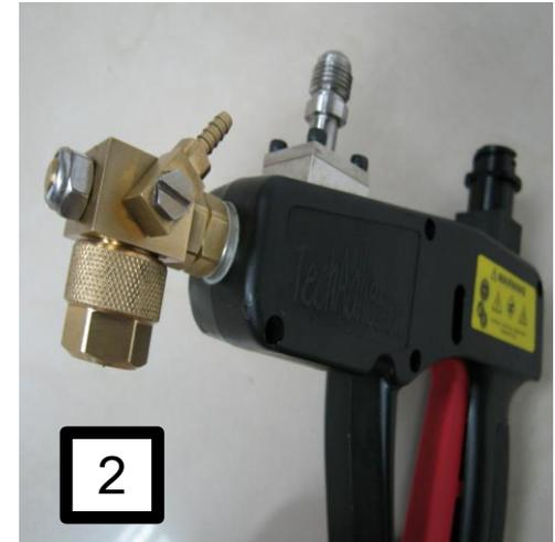
Anche in questo caso, la flessibilità e adattabilità delle nostre pistole permette di poter scegliere la direzione di spruzzo, che può essere dritta (fig. 1) oppure a 90° (fig. 2).
